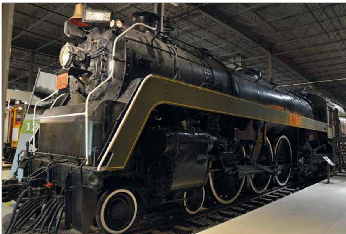
*La 5702, un monstre de puissance avec ses roues de 2,02 m de diamètre (5 septembre 2019).*
